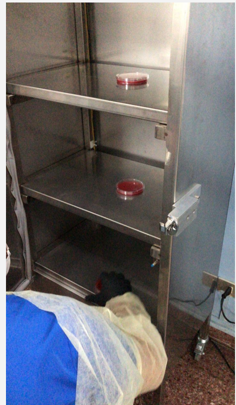
MK-1 operando en Urgencias Hospital Dr. Sótero del Río. Microbiólogo instalando placas de Agar sangre conteniendo bacteria E. Coli para ser expuestas con luz UV. Parte del protocolo de pruebas al que se sometió el Sanitizador UV ASI MK-1 Foto cortesía Hospital Dr. Sótero del Río. Abril 2020
